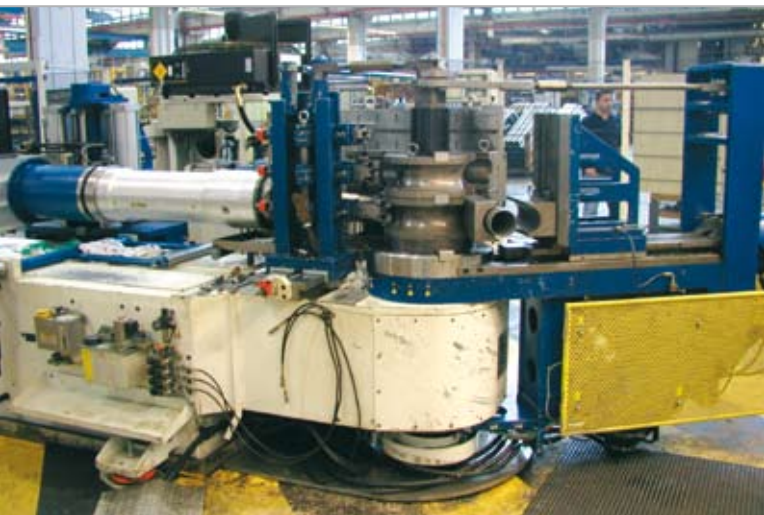
Bogen-in-Bogen- Biegen mit Mehrfachradien- Werkzeugen auf einer Biege- maschine von Schwarze Robitec
