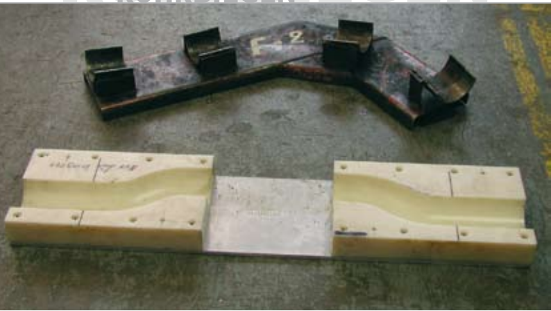
Lehren zur Prüfung der gebogenen Rohre werden heute nur noch für gebaute Teile eingesetzt.
